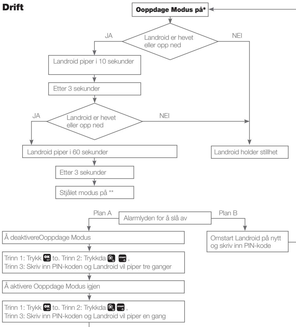
\* Oppdage Modus på: Alarmfunksjonen vil være aktiv. I tillegg, takket være modulens batteri, kan Landroid også støtte denne funksjonen når den er av strømmen.
