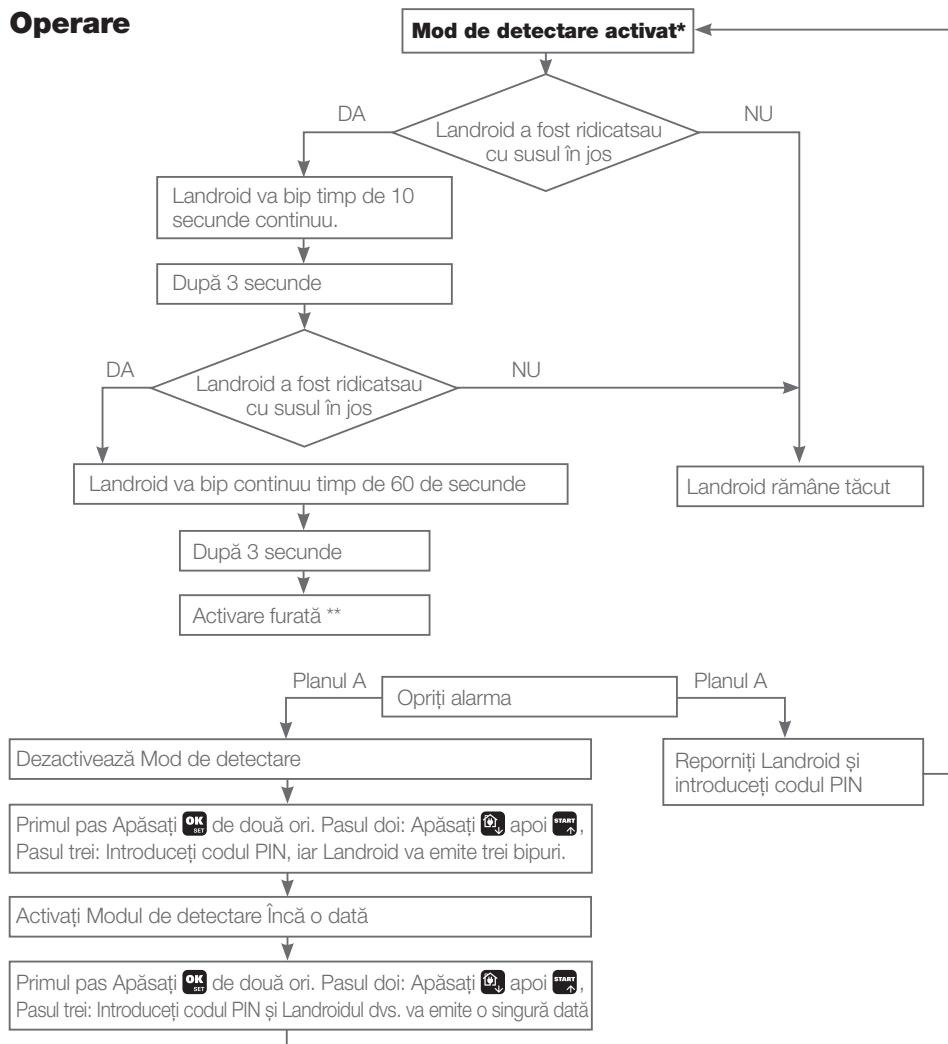
\* Modul de detectare pornește : pornește funcția de alarmă. În plus, datorită bateriei din modul, Landroid vă poate sprijini această funcție atunci când alimentarea este opriță.
