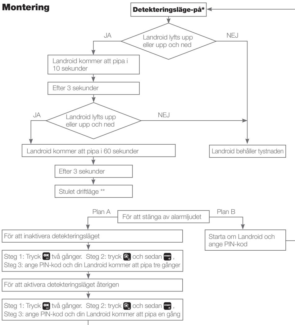
\*Detekteringsläge: Alarmfunktionen kommer att aktiveras. Dessutom, tack vare batteriet i modulen kan din Landroid också stödja den här funktionen när den är avstängd.
