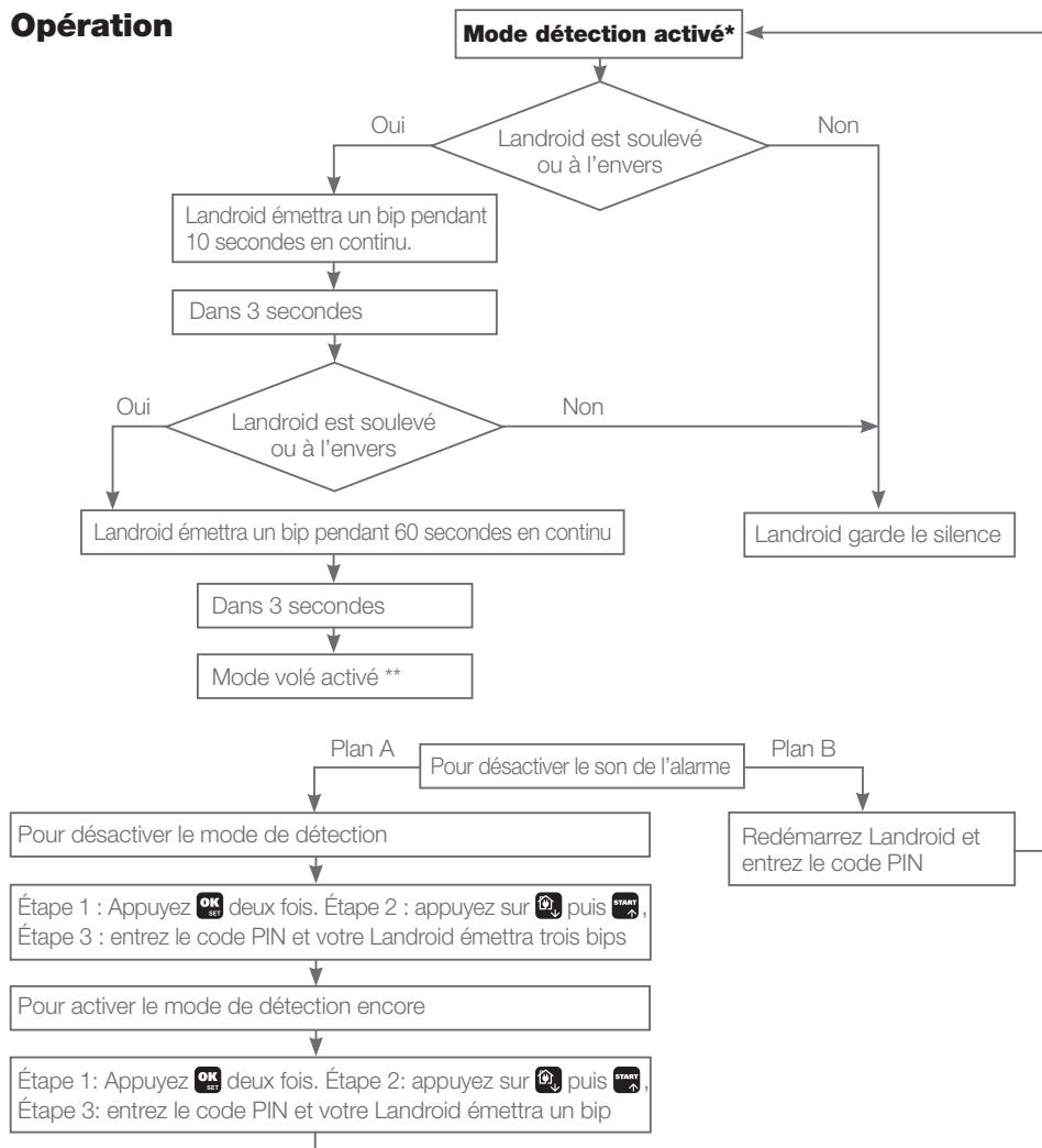
\*Mode de détection activé: la fonction d'alarme sera activée. De plus, grâce à la batterie du module, votre Landroid peut également prendre en charge cette fonction lorsqu'il est hors tension.
