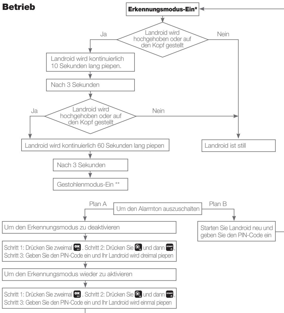
\*Erkennungsmodus-Ein: Die Alarmfunktion wird aktiviert. Darüber hinaus kann Ihr Landroid dank der Batterie im Modul diese Funktion auch im ausgeschalteten Zustand unterstützen.
