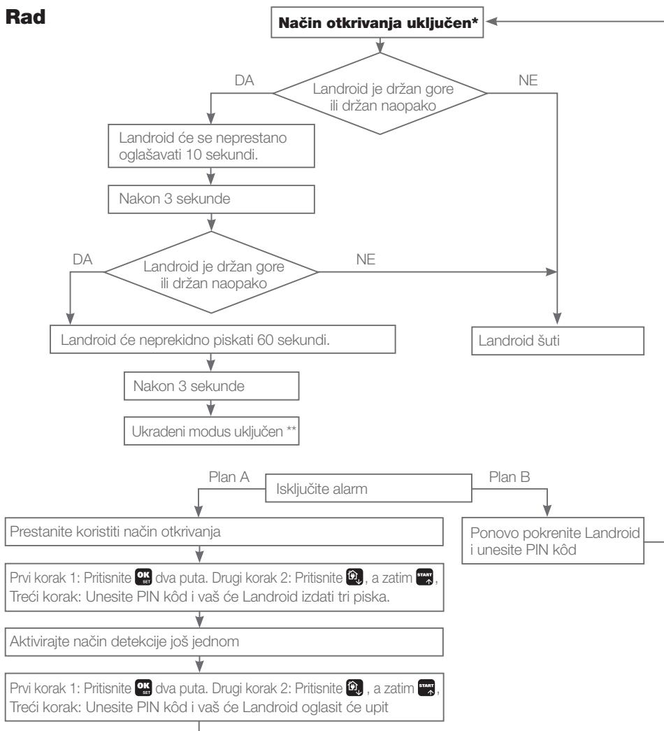
\* Način otkrivanja - uključite: omogućite funkciju alarma. Uz to, zahvaljujući bateriji u modulu, vaš Landroid također može podržati ovu funkciju kada je napajanje isključeno.
