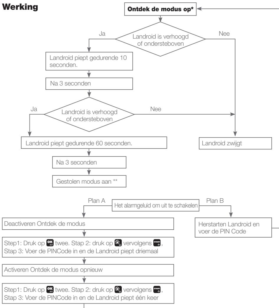
\* Ontdek de modus op :Alarmsfunctie is actief. Bovendien, dankzij de batterij van de module kan Landroid deze functie ook ondersteunen wanneer deze is uitschakeld.
