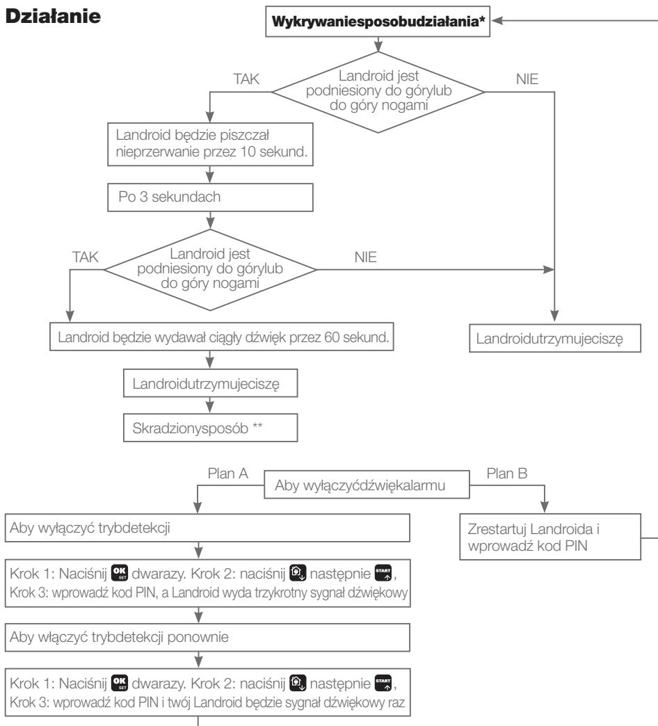
\*Wykrywanie trybu pracy: Funkcja alarmu zostanie włączona. Ponadto, dzięki baterii w module, twój Landroid również może obsługiwać tę funkcję, gdy jest wyłączony.
