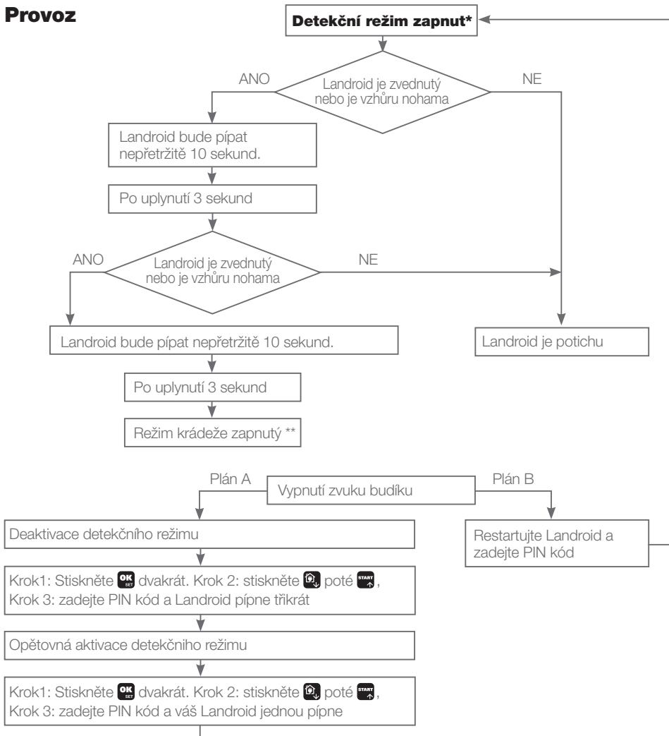
\*Detekční režim zapnutý: Funkce alarmu bude aktivována. Kromě toho díky baterii v modulu může váš Landroid tuto funkci podporovat i při vypnutí.
