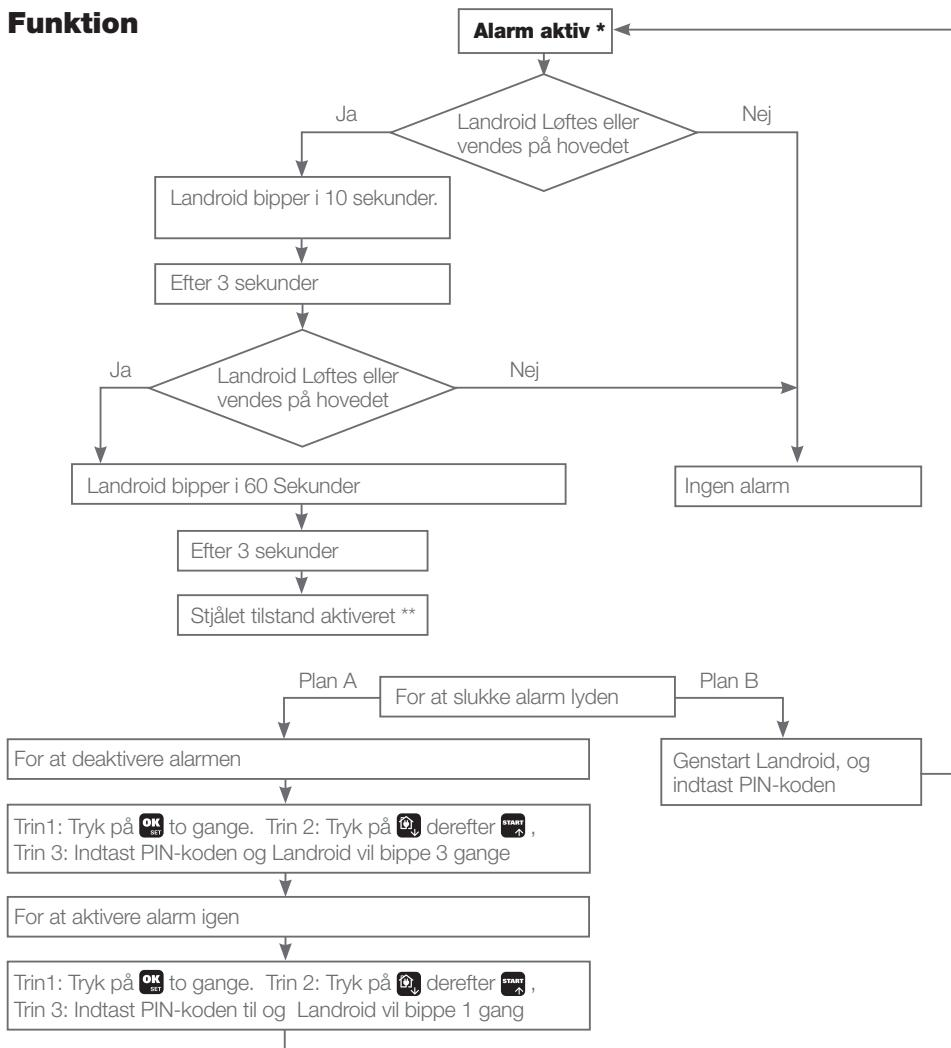
\* Alarm aktiv::: Alarmfunktionen er aktiv. Og takket være modulets batteri, understøtte Landroid også denne funktion, selv når den er slukket.
