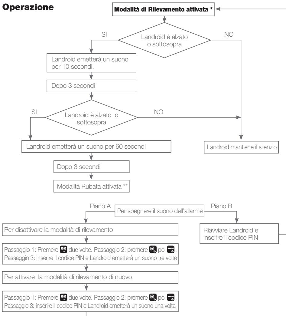
\* Modalità di rilevamento: La funzione di allarme sarà abilitata. Inoltre, grazie alla batteria nel modulo, il tuo Landroid può anche supportare questa funzione quando è spento.
