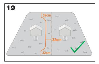
HINWEIS: (nur für Landroid Vision) Stellen Sie sicher, dass der Magnetstreifen 32 cm von der geschützten Fläche und der Grenze entfernt installiert wird. Die Start- und Endpunkte des Magnetstreifens sollten eine Bogenform haben.
