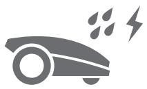
Bescherm Landroid in het geval van onweer door hem los te koppelen van het laadstation, hem los te koppelen van de grensdraad, en ervoor zorgen dat Landroid niet mag opladen. In de winter en vooral bij zeer koud weer en sneeuw raden wij u aan uw Landroid binnen op te slaan. In sommige landen bieden wij een winter service van uw Landroid aan zodat deze klaar is voor het voorjaar. Neem contact op met uw dealer of kijk online voor meer informatie.
