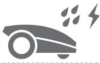
U slučaju grmljavinskog nevremena, zaštite Landroid tako da postolje za punjenje iskopčate iz napajanja, odspojite graničnu žicu i pazite da se Landroid ne puni. Zimi, a osobito u slučaju vrlo hladnog vremena i snijega, preporučujemo da Landroid pohranite u zatvorenom prostoru. U nekim državama pružamo zimske servise kako bi Landroid bio spremna za sezonu proljetnog rasta. Za više pojedinosti obratite se dobavljaču ili provjerite online.
