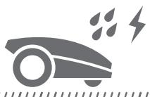
V případě bouřky chraňte sekačku Landroid odpojením nabíjecí stanice, odpojením okrajového drátu a ujištěním se, že se sekačka Landroid nemůže nabíjet. V zimě, a zejména při velmi chladném počasí a sněhu, doporučujeme uskladnit sekačku uvnitř budovy. V některých zemích nabízíme zimní servis vaší sekačky, tak aby byla připravena na jaro. Obratěte se na svého prodejce nebo vyhledejte informace online.
